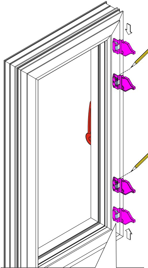
Chiudere l'anta , spostare la dima nel senso della freccia fino al suo fermo e segnare la posizione sul telaio.
